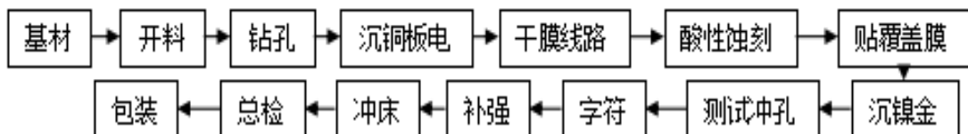
图 2.1.6-3 软板电路板生产工艺流程图
